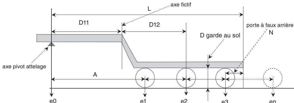
Dimensions en millimètres, masses en kg. Essieux numérotés de l'avant vers l'arrière
