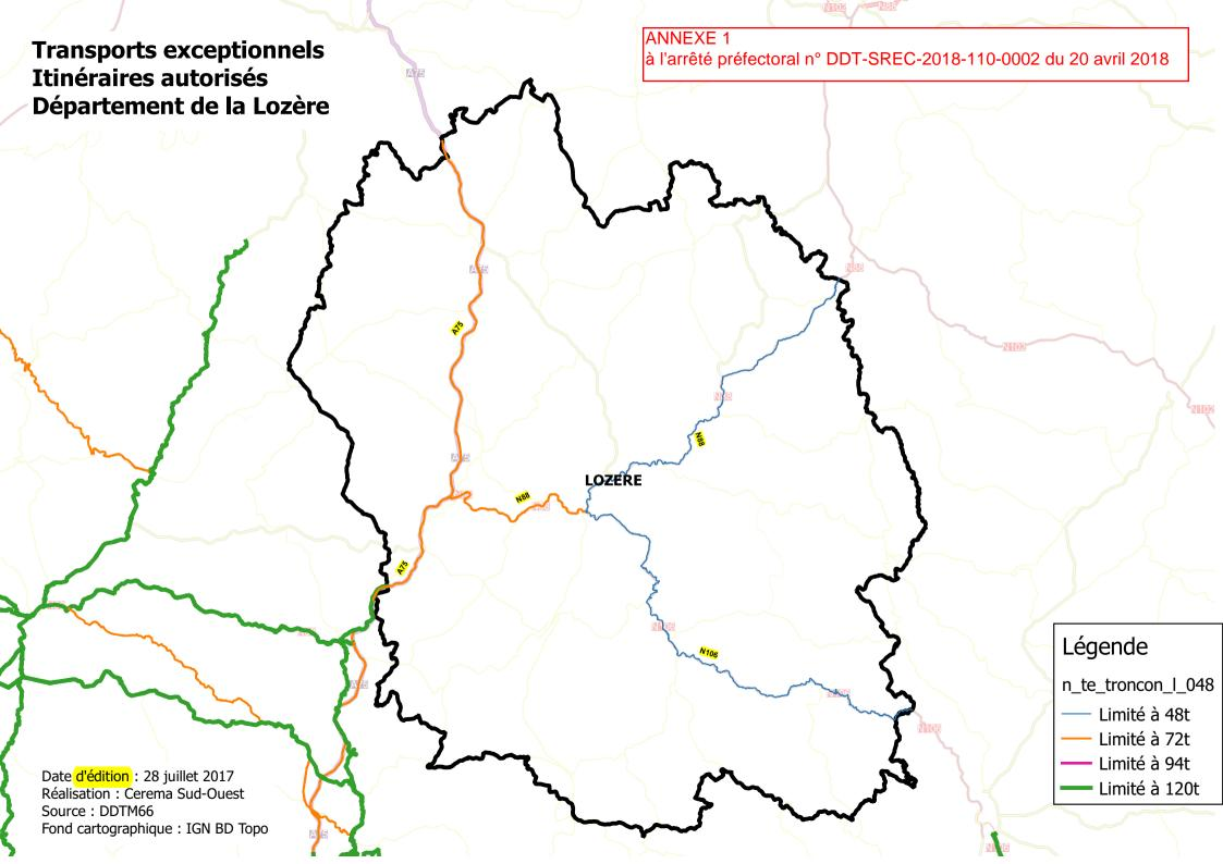
Annexe 2 : voies constituant le réseau « 72 tonnes » accessible aux convois de moins de 72 tonnes de charge totale, moins de 12 tonnes à l'essieu et plus de 1,36 m entre les essieux
